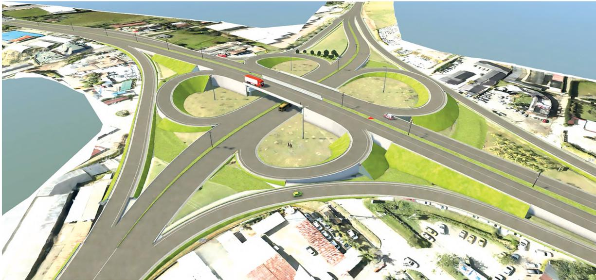
Proyecto de intercambio vial en doble calzada tipo **trébol**, con vías a desnivel para conexión Llanogrande - Guarne y Las Palmas - Aeropuerto JMC - Render: Gobernación de Antioquia.
